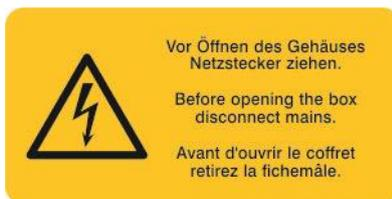
Dieses Symbol warnt davor, das Gerät zu öffnen, während eine Verbindung zum Stromnetz besteht. Bei Nichtbeachtung dieses Symbols entstehen Risiken für Personen, die an dem Gerät arbeiten oder sich in der Nähe befinden. Des Weiteren entstehen Risiken für Sachwerte.
